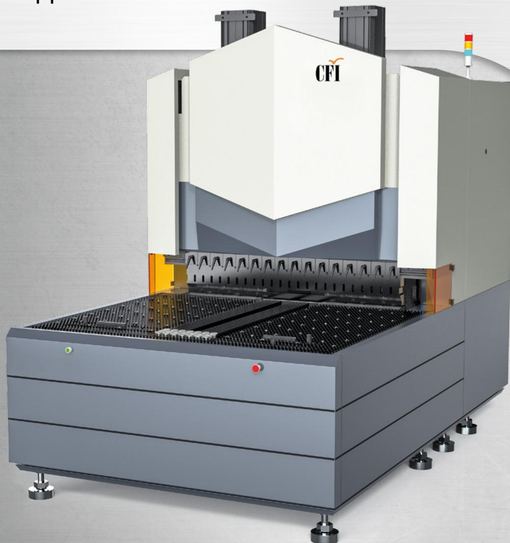
Станки серии LHA-XC фиксируют заготовку посредством комплекта вакуумных присосок. В стандартную комплектацию входят наборы с различным количеством присосок (5, 7, 10 и 21 шт.) для деталей разных габаритов. Вторая по популярности модель панелегиба в Китае.
